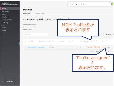
6. 右側の画面が表示され、"Profile" 欄にMDM Profile名、"Status"欄 に"Profile assigned"が表示されます。
